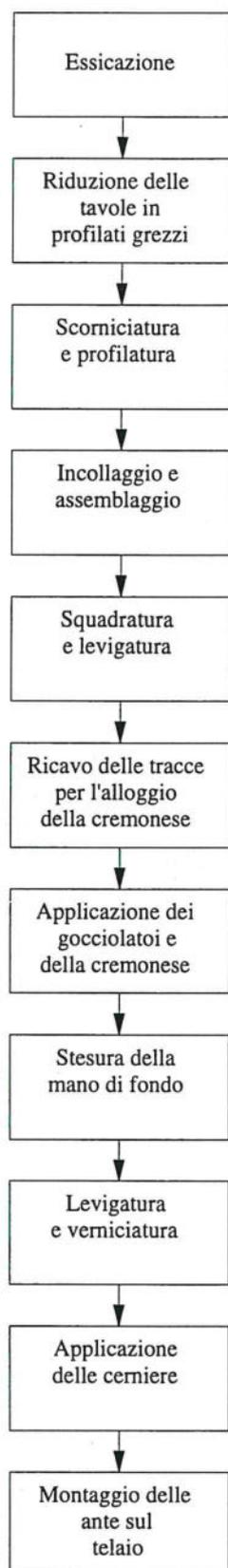
Figura 1-4 Schema di lavorazione di una finestra (Fonte: Bellandi).
